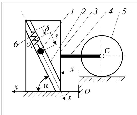
**30.** Шарик 1 массой  $m_1$ , двигаясь по гладкому пазу 2 с углом наклона  $\alpha$  к горизонту, приводит в движение по гладкой горизонтальной плоскости тело 3 массой  $m_3$ , внутри которого находятся паз 2 и шарик 1. Тело 3 с помощью стержня 4 шарнирно соединено с центром катка 5. Каток 5 – однородный круглый цилиндр массой  $m_5$  и радиусом  $r$  катится по горизонтальной плоскости без скольжения.
