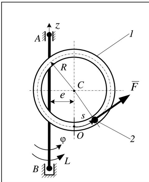
**19.** Гладкая трубка 1 массой  $m_1$  свернута в кольцо радиусом  $R$  и жестко с эксцентриситетом  $e$  закреплена на вертикальном валу  $AB$ , который может вращаться вокруг оси  $Az$  под действием пары сил с постоянным моментом  $L$ . Внутри трубки под действием силы  $\bar{F}$ , направленной по касательной к трубке, движется шарик 2 массой  $m_2$ . Массу трубки считать равномерно распределенной по окружности радиусом  $R$ .
