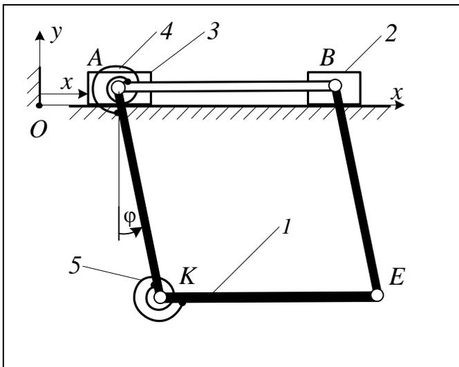
**16.** Подвижный параллелограмм 1 шарнирно прикреплен к ползунам 2 и 3 одинаковой массы  $m_2$ . Ползуны могут перемещаться по гладкой горизонтальной плоскости. Масса стержней  $AB, BE$  и  $AK$  одинакова и равна  $m_1$ , масса стержня  $KE$  равна  $m_6$ , длины стержней одинаковы и равны  $2l$ . Стержень  $AK$  спиральными пружинами 4 и 5 одинаковой жёсткости  $c$  соединен со стержнями
