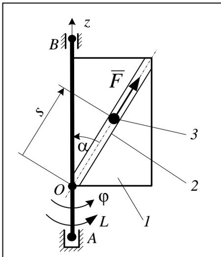
**8.** На однородной пластине 1 массой  $m_1$  жёстко закреплена гладкая трубка 2 длиной  $l$ , которая образует угол  $\alpha$  с осью  $Az$ . Пластина установлена на вертикальном валу  $AB$ . Внутри трубки движется шарик 3 массой  $m_3$ . К шарiku приложена постоянная по величине сила  $\bar{F}$ , направленная вдоль трубки, а к валу – пара сил с постоянным моментом  $L$ . Момент инерции трубки относительно оси вращения равен  $J = 2m_3l^2$ . Трением в опорах  $A$  и  $B$  пренебречь.
