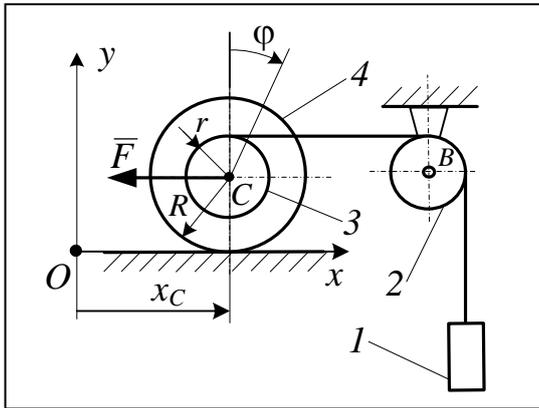
1. Груз 1 массой  $m_1$  прикреплен к нерастяжимой нити, переброшенной через блок 2 массой  $m_2$  и намотанной на барабан 3 радиусом  $r$  катка 4, который катится по горизонтальным направляющим со скольжением. Радиус катка  $R = 3r$ , общая масса барабана и катка  $M$ , их центр масс  $C$  лежит на оси катка, а радиус инерции относительно оси катка  $\rho = 2r$ . Коэффициент трения скольжения между катком и направляющими –  $f$ , коэффициент трения качения –  $\delta$ .
