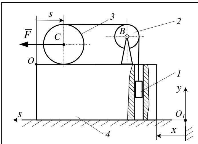
4. Груз 1 массой  $m_1$ , опускаясь, посредством нерастяжимой нити, переброшенной через блок 2 массой  $m_2$  и намотанной на каток 3 массой  $m_3$ , приводит каток в движение. К центру  $C$  катка приложена внешняя постоянная по величине горизонтальная сила  $\bar{F}$ . Каток катится без скольжения по плите 4 массой  $m_4$ .
