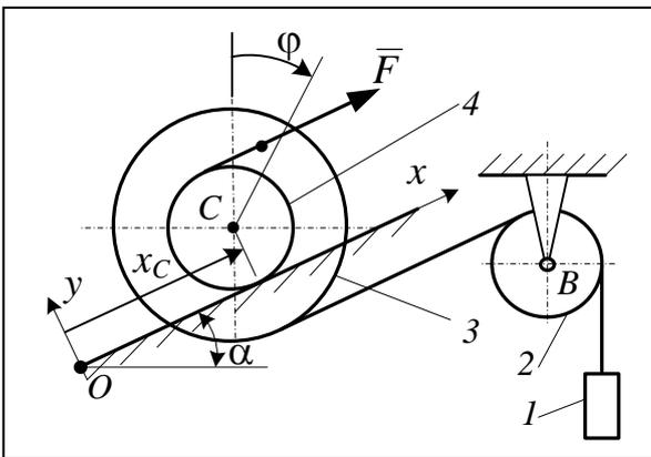
2. Груз 1 массой  $m_1$  прикреплен к нерастяжимой нити, переброшенной через блок 2 массой  $m_2$  и намотанной на барабан 3 катка 4, который может катиться со скольжением по наклонным направляющим, образующим угол  $\alpha$  с горизонтом. Барабан 3 радиусом  $R$  жестко связан с катком 4 радиусом  $r = R/3$ , их общая масса равна  $m_3$ , центр масс  $C$  барабана и катка лежит на оси катка, их общий радиус инерции относительно оси катка  $\rho = 2r$ .
