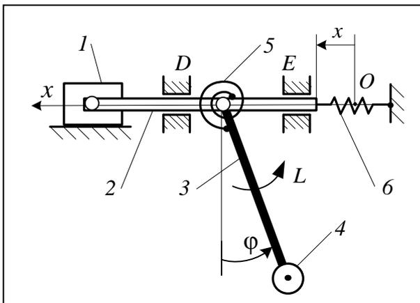
**20.** Механическая система состоит из ползуна 1, который может двигаться по гладкой горизонтальной плоскости, стержней 2, 3 и материальной точки 4 массой  $m_4$ . Стержень 2, который движется в гладких направляющих, и стержень 3 связаны между собой шарнирно и скреплены спиральной пружиной 5 с коэффициентом жёсткости  $c_5$  (момент упругих сил пружины  $L_{Oz} = -c_5\varphi$ ,  $\varphi$  - угловая
