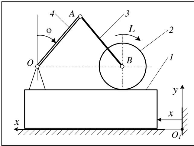
9. На гладкой плоскости расположен механизм, состоящий из плиты 1 массой  $m_1$ , на которой находится устройство, состоящее из однородного катка 2 массой  $m_2$  и двух стержней 3 и 4 длиной  $l$  каждый. Звенья 2, 3, 4 соединены между собой, с катком и с плитой шарнирами  $A, B$  и  $O$ . Масса стержня 4 равна  $m_4$ . Каток 2 катится по плите 1 без скольжения и к нему приложена пара сил с моментом  $L=L(t)$ . Трением качения пренебречь.
