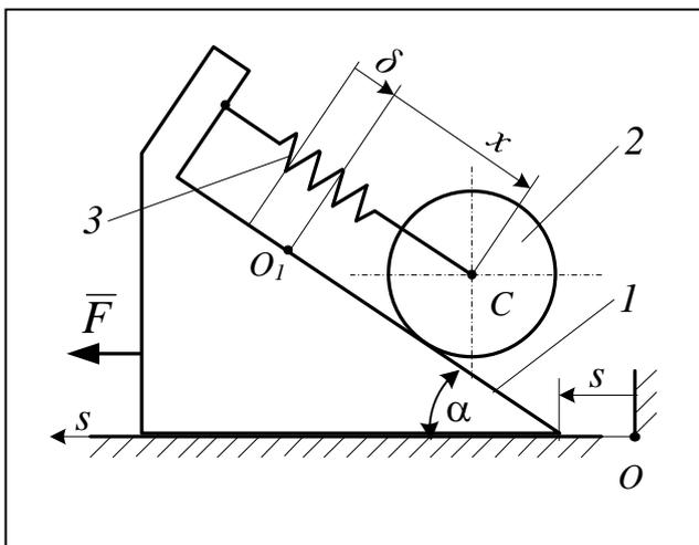
**26.** Призма 1 массой  $m_1$  может двигаться по гладкой горизонтальной плоскости. К призме приложена постоянная внешняя сила  $\bar{F}$ . По грани призмы, наклоненной к горизонту под углом  $\alpha$ , катится без скольжения однородный цилиндр 2 массой  $m_2$  и радиусом  $r$ . Цилиндр 2 в точке  $C$  скреплен со стойкой на призме пружиной жёсткости  $c$ , параллельной наклонной грани призмы.
