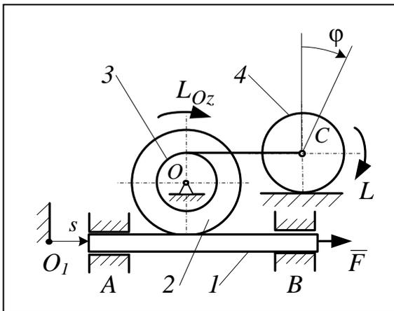
**32.** Зубчатая рейка 1 массой  $m_1$  движется в гладких направляющих под действием постоянной горизонтальной силы  $\vec{F}$ . Рейка находится в зацеплении с шестерней 2 радиусом  $R$ . С шестерней 2 жестко связан барабан 3 радиусом  $r$ . На барабан намотана нерастяжимая нить, прикрепленная к центру  $C$  однородного катка 4 массой  $m_4$  и радиусом  $r_4$ , который катится со скольжением по горизонтальной плоскости. Коэффициент трения скольжения равен  $f$ , Момент инерции
