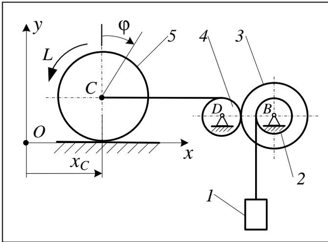
3. Груз 1 массой  $m_1$ , опускаясь, с помощью нерастяжимой нити приводит во вращение ступенчатый барабан 3 ( $r, R=2r$  – радиусы ступеней 2 и 3 соответственно); радиус инерции барабана относительно его оси вращения –  $\rho$ ,  $m_3$  – его масса. На большей ступени барабана имеется зубчатое колесо, которое находится в зацеплении с шестерней – барабаном 4 радиусом  $r$  и массой  $m_4$ . На барабан 4 намотана
