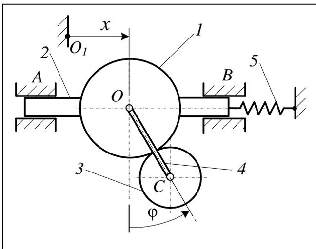
5. Зубчатое колесо 1 жёстко связано с рейкой 2, движущейся поступательно в неподвижных гладких направляющих A и B. Совместная масса зубчатого колеса 1 и рейки 2 равна  $m_1$ . Шестерня 3 массой  $m_2$ , радиусом  $r$  обкатывает зубчатое колесо 1 и связана с последним шарнирно с помощью водила 4 длиной  $l$ . Рейка 2 соединена с неподвижным основанием через пружину 5 с коэффициентом жёсткости  $c$ . В начальном
