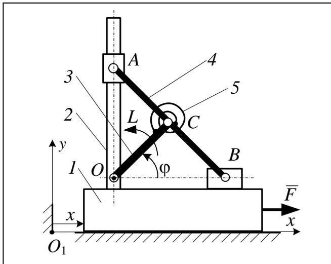
**29.** Плита 1 со стойкой 2 общей массой  $m_1$  может совершать движение по гладкой горизонтальной плоскости. На плите помещен эллипсограф, состоящий из кривошипа 3, линейки 4 и ползунов A и B. Массы кривошипа и линейки эллипсографа равны соответственно  $m_3$ ,  $m_4$ . В шарнире C между кривошипом и линейкой установлена спиральная пружина 5 с коэффициентом жёсткости  $c$ . К плите приложена постоянная сила  $\bar{F}$ , а к кривошипу 3 – пара сил с
