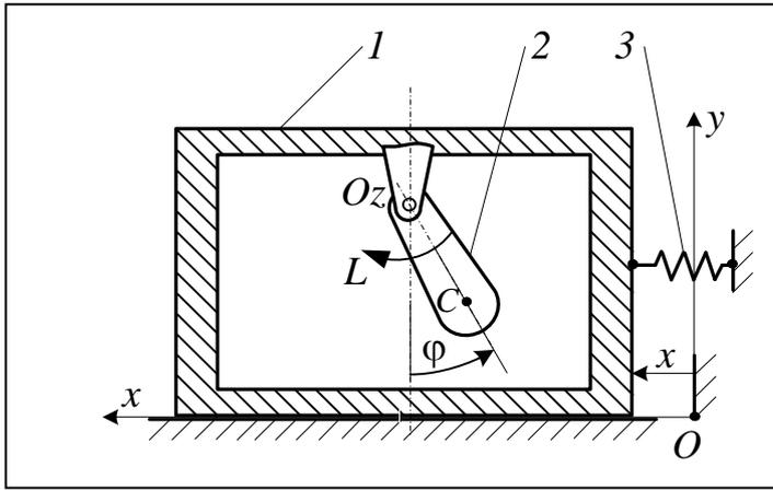
**23.** Контейнер 1 массой  $m_1$  может двигаться по гладкой горизонтальной плоскости. На горизонтальной оси  $Oz$  внутри контейнера закреплен физический маятник 2 массой  $m_2$ . При этом контейнер соединен с неподвижным телом пружиной 3 с коэффициентом жёсткости  $c$ . Момент инерции маятника 2 относительно оси вращения  $Oz$
