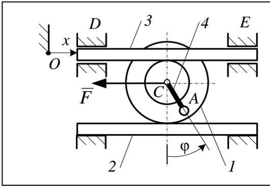
**7.** Механическая система состоит из ступенчатого зубчатого колеса 1 массой  $m_1$  и радиусами ступеней  $r$  и  $R$ . Радиус инерции колеса 1 относительно оси  $Cz$ , перпендикулярной плоскости чертежа –  $\rho$ . Колесо 1 находится в зацеплении с неподвижной зубчатой рейкой 2 и подвижной зубчатой рейкой 3 массой  $m_3$ .
