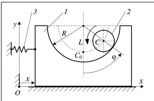
**22.** В бруске 1 массой  $m_1$  имеется цилиндрическая выемка радиусом  $R$ , внутри этой выемки может катиться без скольжения однородный круглый цилиндр 2 массой  $m_2$  и радиусом  $r$ . Оси выемки и цилиндра параллельны. Брус находится на горизонтальной гладкой плоскости и соединен с неподвижным телом посредством
