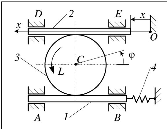
**18.** Рейки 1 и 2 массой  $m_1$  и  $m_2$  соответственно находятся в зацеплении с колесом 3 и движутся в горизонтальных гладких направляющих  $AB$  и  $DE$ . Колесо 3 массой  $m_3$  и радиусом  $r$  приводится в движение парой сил с моментом  $L$ . Кроме того, рейка 1 соединена с неподвижным основанием посредством пружины 4 с коэффициентом жёсткости  $c$ .
