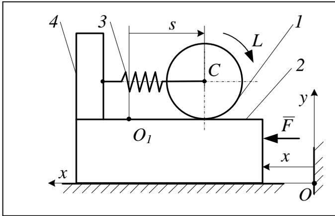
**13.** Однородный цилиндрический каток 1 массой  $m_1$  и радиуса  $R$  катится без скольжения по плите 2 массой  $m_2$ . Плита движется по горизонтальной гладкой плоскости под действием постоянной силы  $\bar{F}$ . Центр  $C$  катка связан пружиной 3 с коэффициентом жёсткости  $s$ , параллельной указанной плоскости, с вертикальной стойкой 4, жестко скрепленной с плитой 2.
