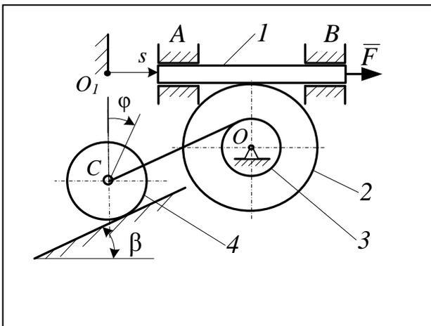
**14.** В механической системе рейка 1 массой  $m_1$  движется в горизонтальных гладких направляющих  $A$  и  $B$  под действием постоянной силы  $\bar{F}$ . Рейка находится в зацеплении с шестерней 2 радиусом  $R$ , с которой жестко связан барабан 3 радиусом  $r$ . Радиус инерции шестерни 2 и барабана 3 относительно их оси вращения равен  $\rho$ ,  $m_2$  – их общая масса. К центру  $C$  однородного катка 4 массой  $m_4$  прикреплена нерастяжимая
