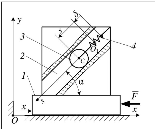
28. На гладкой плоскости находится массивная плита 1 массой  $m_1$ , в которой имеется наклоненный под углом  $\alpha$  к горизонту прямолинейный паз 2. К плите приложена горизонтальная сила  $\bar{F}$ . По пазу 2 катится без скольжения однородный диск 3 массой  $m_3$  и радиусом  $r$ . При этом центр  $C$  диска соединен с точкой  $O_1$  плиты пружиной 4 с коэффициентом жёсткости  $c$ . Статическая (в состоянии покоя системы) деформация пружины равна  $\delta$ .
