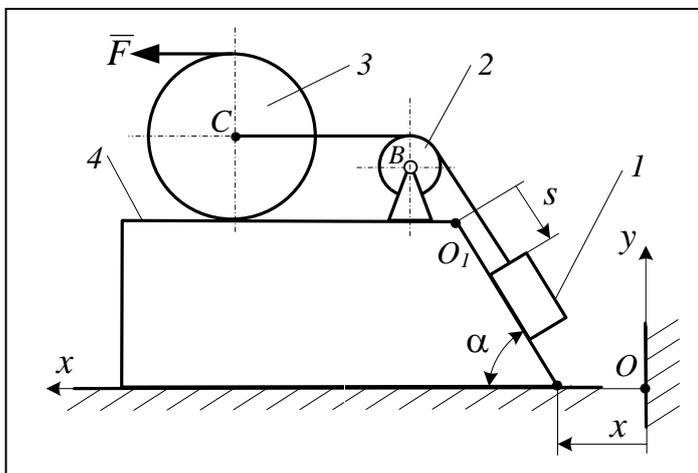
6. Груз 1 массой  $m_1$  закреплен на нерастяжимой нити, переброшенной через блок 2 массой  $m_2$ , прикрепленной к центру C катка 3, и может двигаться по гладкой наклонной грани призмы 4 с углом  $\alpha$  к горизонту. Каток 3 массой  $m_3$  катится без скольжения по верхней горизонтальной грани призмы 4 массой  $m_4$ , которая находится на гладкой горизонтальной плоскости.
